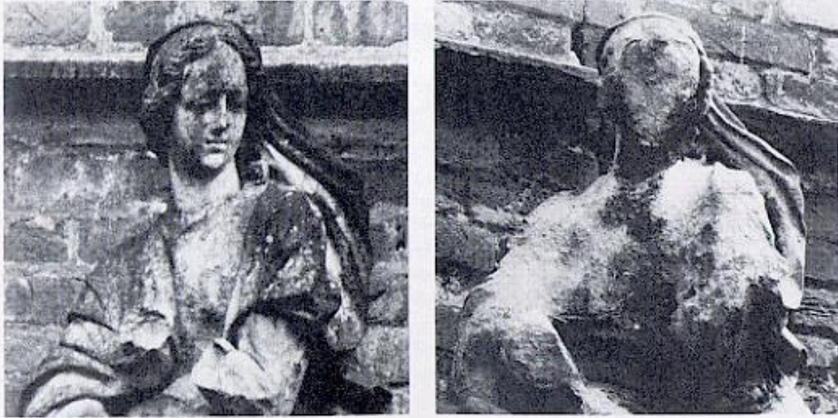
Figure 23.15 A monument before and after deterioration caused by acid rain. [ Westfälisches Amt für Denkmalpflege. ]
